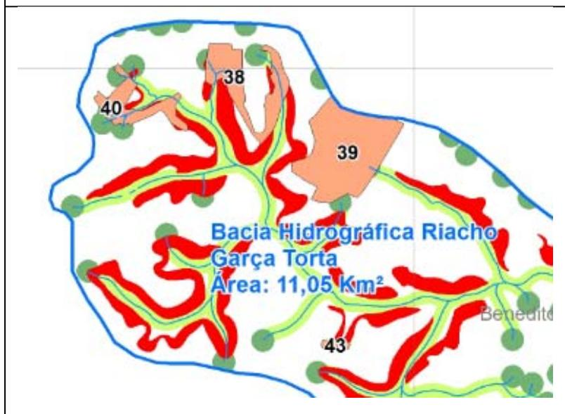
Figura 15: Bacia do Riacho Garça Torta em seu trecho de montante, onde são identificados assentamentos precários: Conjunto Geraldo B, Benício Mendes, Grotas Bela Vista, localizados próximos às áreas críticas de deslizamento em vermelho e APP em verde. Fonte: MJ Engenharia.
