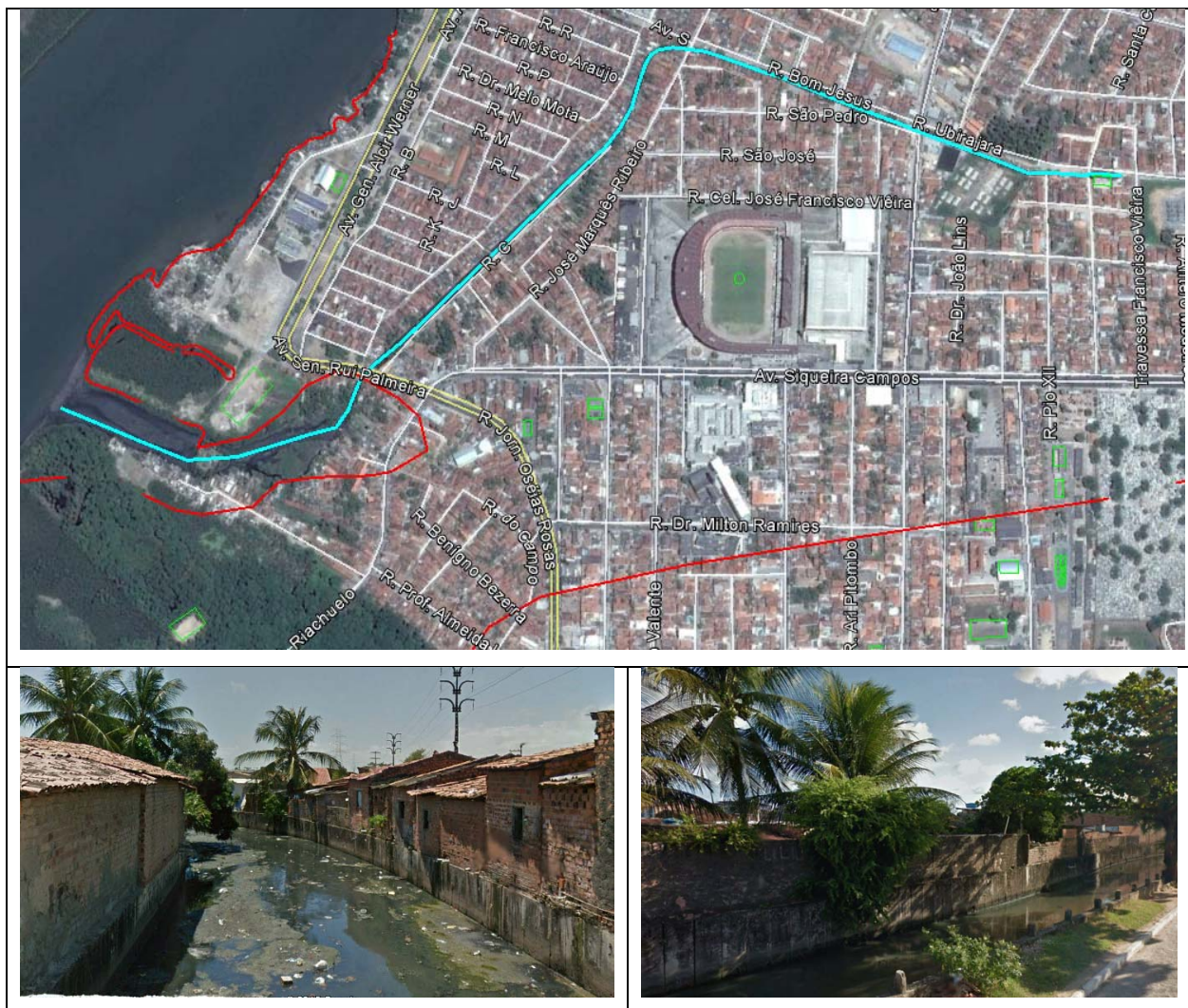
Figura 29: Rua Bom Jesus – Canal aberto, paredes revestidas em concreto armado, com extensão de 1850 m. Fonte: Autor. Base Google Earth e vistoria “in loco”.
