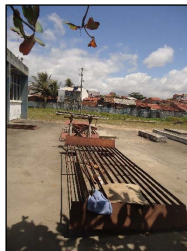
Figuras 24 e 25. Unidades de Gradeamento da ETE – Disposição Oceânica e detalhe para Gradeamentos não instalados.
