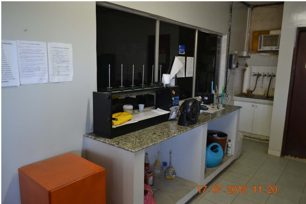
Figura 32. Sala de operação, maquinário de teste de jarros. Fonte: MJ Engenharia.
