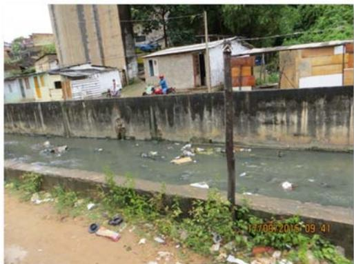
Figura 74 - Assoreamento associado à disposição irregular de resíduos e contaminação das águas do riacho Reginaldo. Fonte: MJ Engenharia. Data do Registro: 17/09/2015.
